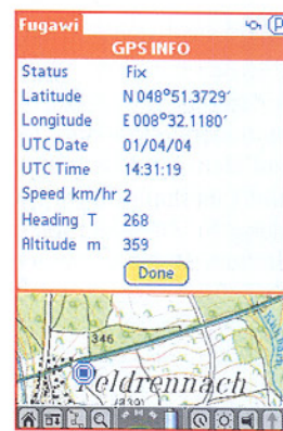
Bild 12: Positions- cursor in der kalibrierten Karte und GPS Info von Fugawi
