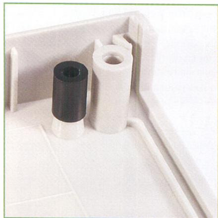
Bild 11: Gehäuseunterseite mit bereits aufgeklebten Distanzrollen
