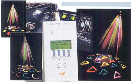
▲ DMX-Analyser DA 512, Teil 2 Vielseitig einsetzbarer Analyser für die Kontrolle, Fehlersuche und Inbetriebnahme von DMX-Systemen Seite 62
